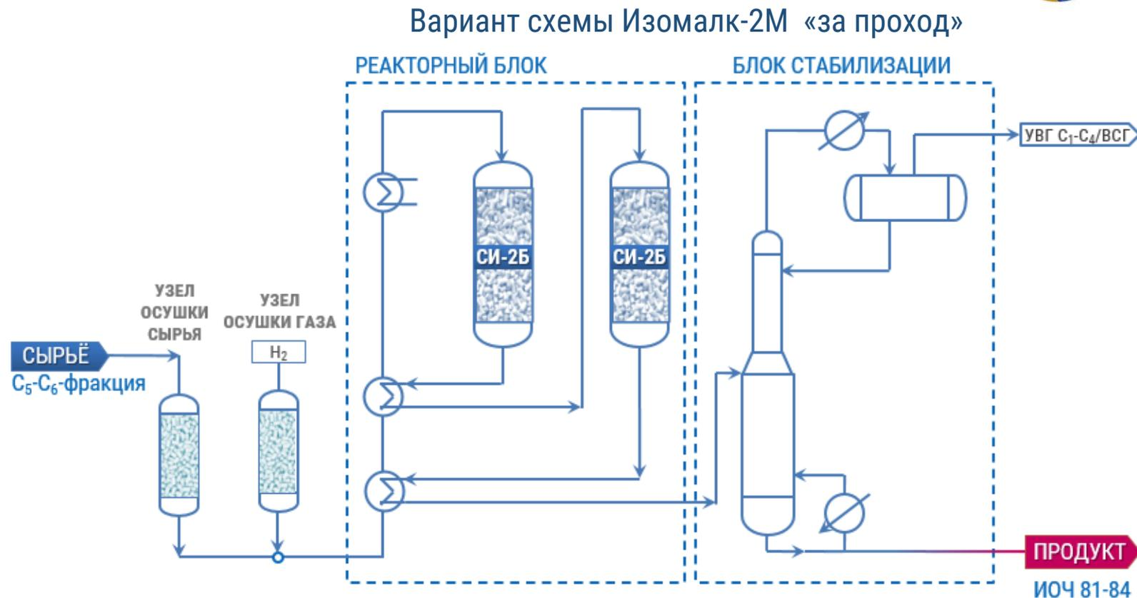
Возможность перевода действующих установок изомеризации с хлорированного катализатора на технологию ИЗОМАЛК-2М с использованием катализатора СИ-2Б
